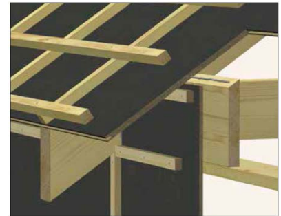
Seinän ja katon liitos, räystäälle jatkuvat yläpaarteet
